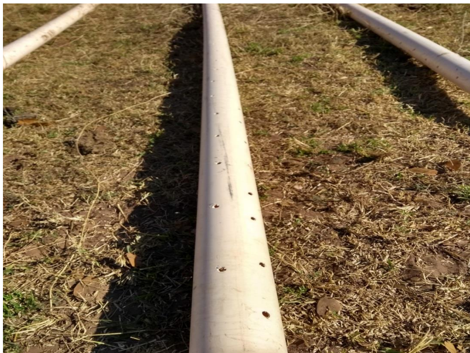
Figura 18 – Pequenos furos feitos nos tubos para vazão.
