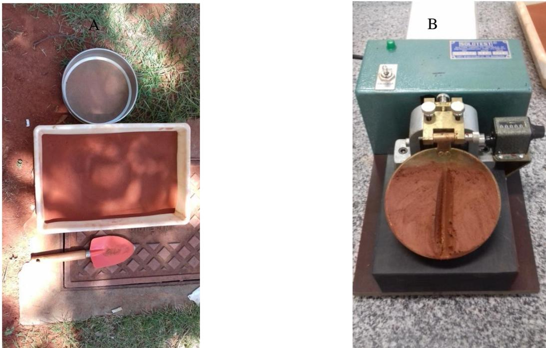
Figura 2- Peneiramento do solo (A) e prato de latão preenchido com solo úmido com a linha de escoamento do material ao centro feita com o auxílio do cinzel (B).
