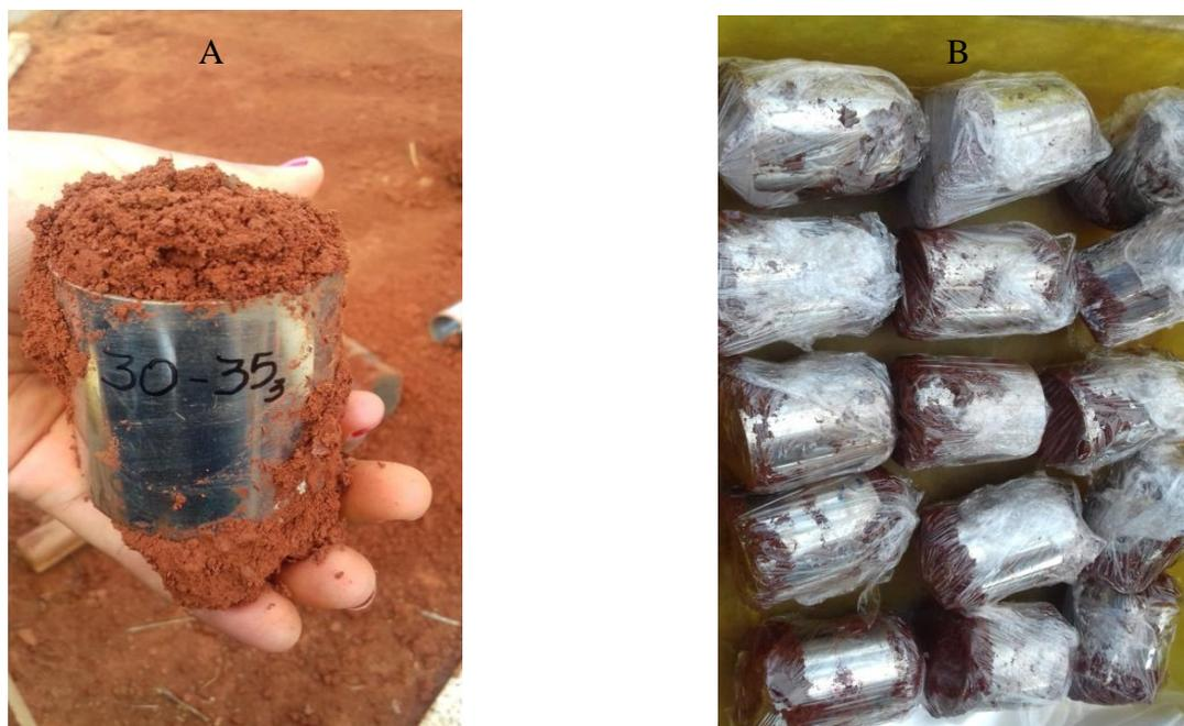
Figura 4- Identificação das amostras (A) e condicionamento das amostras (B) em campo.
