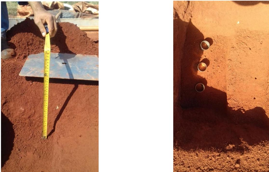
Figura 8- Medição da profundidade para coleta das amostras (A) e coleta das amostras em diferentes profundidades na camada de 0-60 cm (B).
