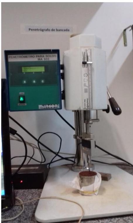
Figura 7- Medição da resistência mecânica do solo a penetração no laboratório de física e mecânica do solo – UFMT, Rondonópolis- MT.
