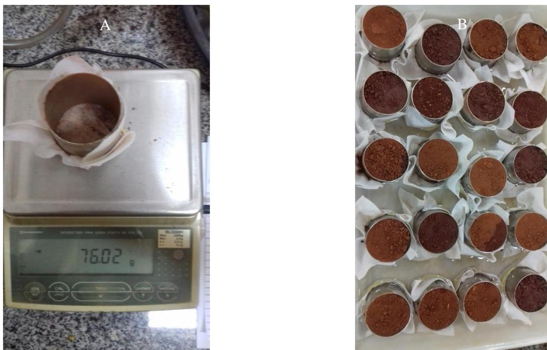
Figura 6- Pesagem dos anéis (A) e saturação das amostras (B) no laboratório de física e mecânica do solo – UFMT, Rondonópolis- MT.
