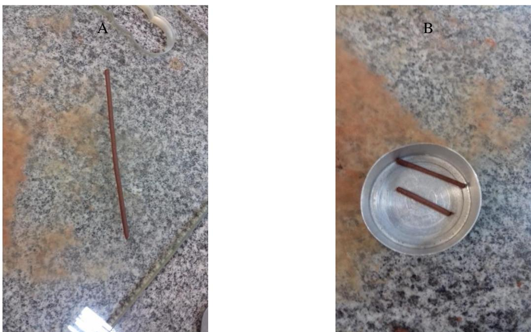
Figura 3- Modelagem do solo de modo a obter um cilindro de 3 mm de diâmetro e cerca de 10 cm de comprimento (A) e porção do solo do local da fragmentação do cilindro (B).
