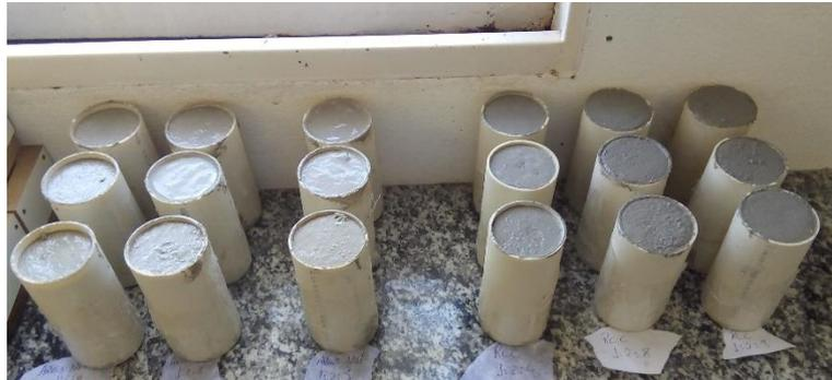
**Figura 16** - Moldes de corpo de prova cilíndricos
