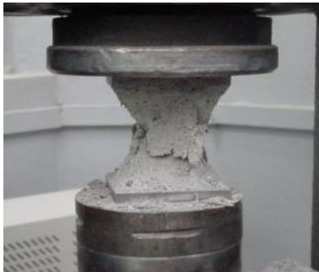
**Figura 5** - Determinação da resistência à compressão simples
