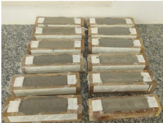
**Figura 15** - Moldes de corpo de prova prismáticos
