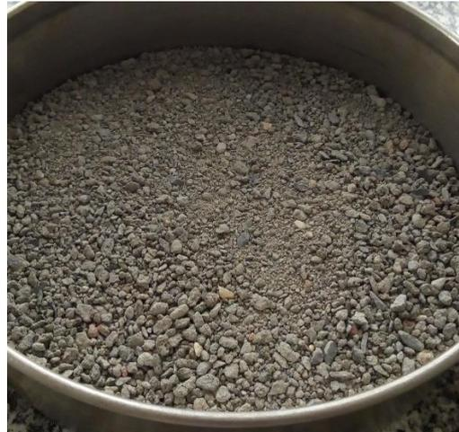
**Figura 10** - Resíduo de blocos de concreto beneficiado
