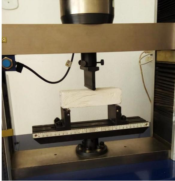
**Figura 17** - Ensaio de resistência à tração na flexão conforme ABNT NBR 13279/2005
