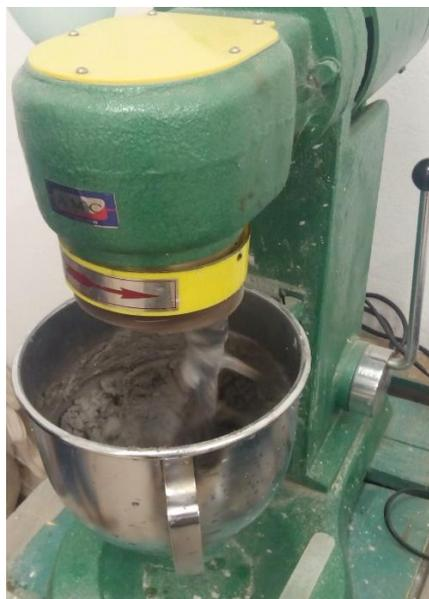
**Figura 14** - Argamassadeira automática utilizada para mistura da argamassa
