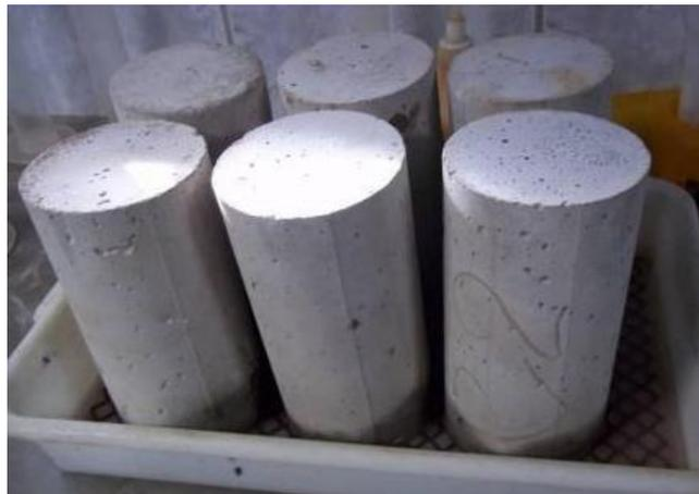
**Figura 7** - Determinação da absorção de água por capilaridade
