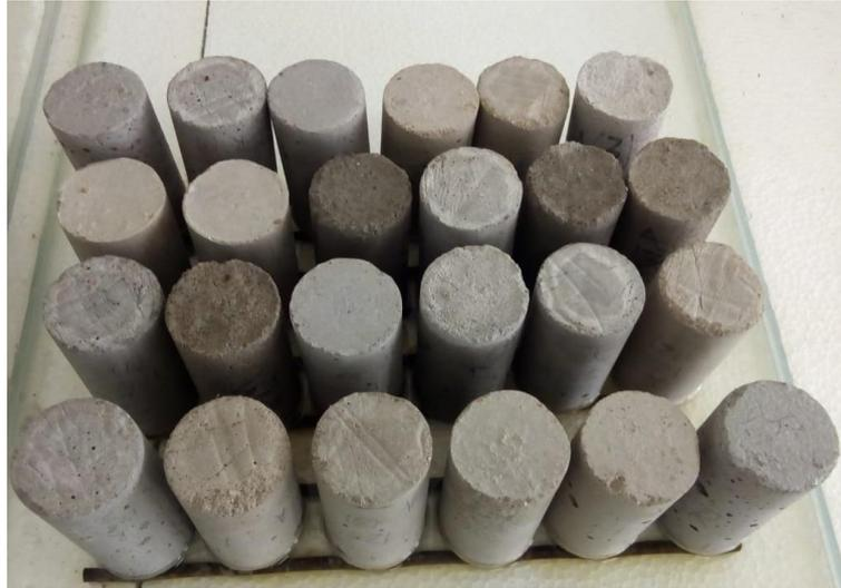
**Figura 19** - Ensaio para determinação da absorção de água por capilaridade
