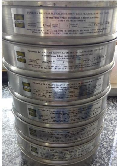
**Figura 11** - Série de peneiras normal conforme a ABNT NBR NM 248/2003
