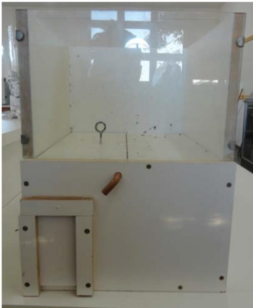
**Figura 3.** Dispositivo para determinação experimental do ângulo de repouso.
