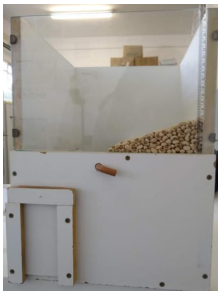
FIGURA 1. Dispositivo utilizado para determinação experimental do ângulo de repouso e detalhe do talude formado pelos grãos de feijão caupi.
