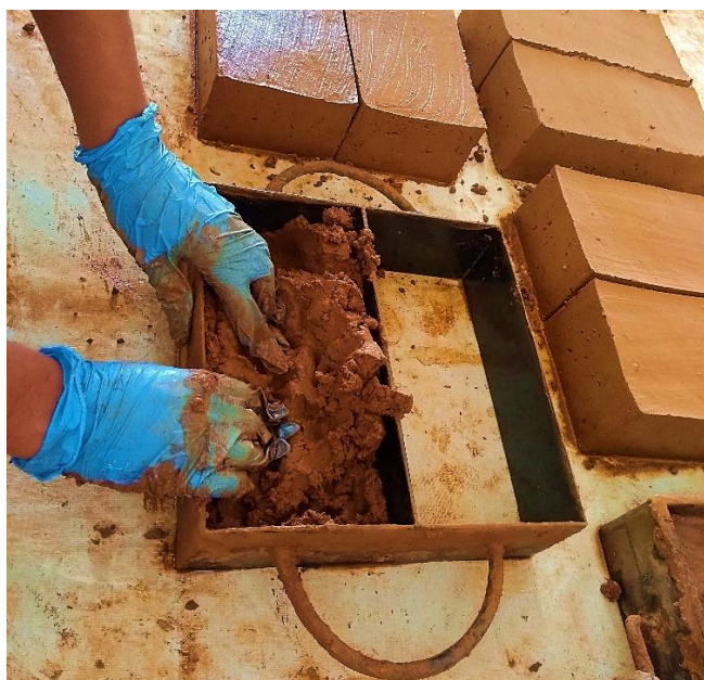
Figura 9 - Moldagem de tijolos de adobe.
