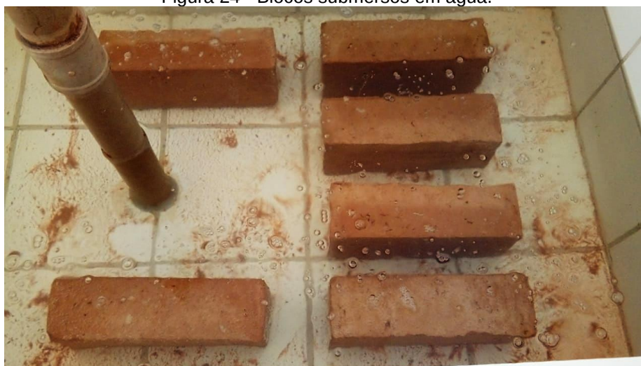
Figura 24 - Blocos submersos em água.
