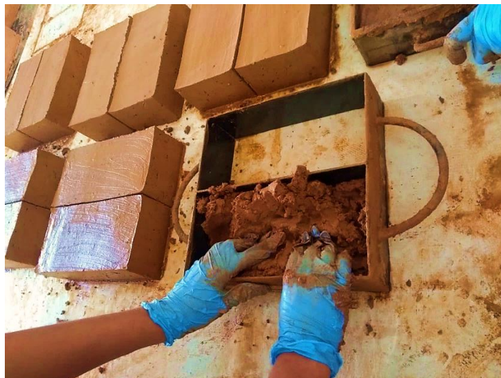
Figura 20 - Moldagem dos blocos de adobe.
