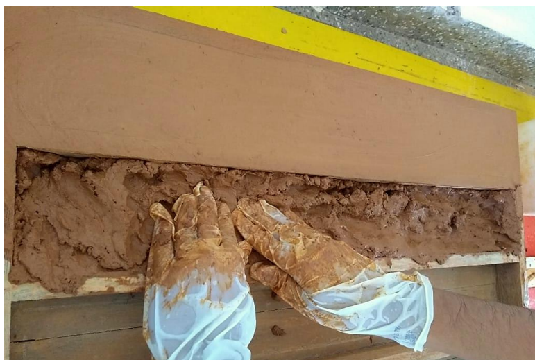
Figura 22 - Distribuição da mistura dentro da caixa.
