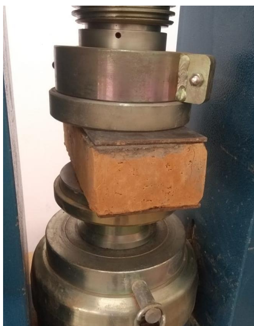
Figura 23 - Ensaio de resistência à compressão simples.
