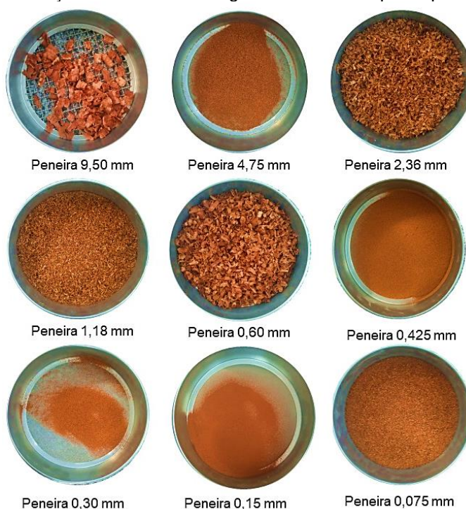
Figura 33 - Frações retidas de serragem de madeira após o peneiramento.
