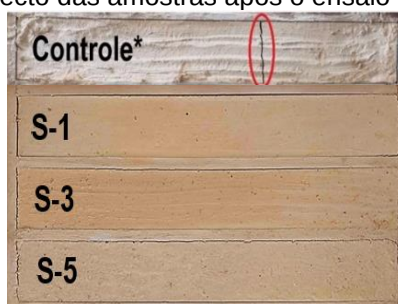
Figura 35 - Aspecto das amostras após o ensaio de retração.
