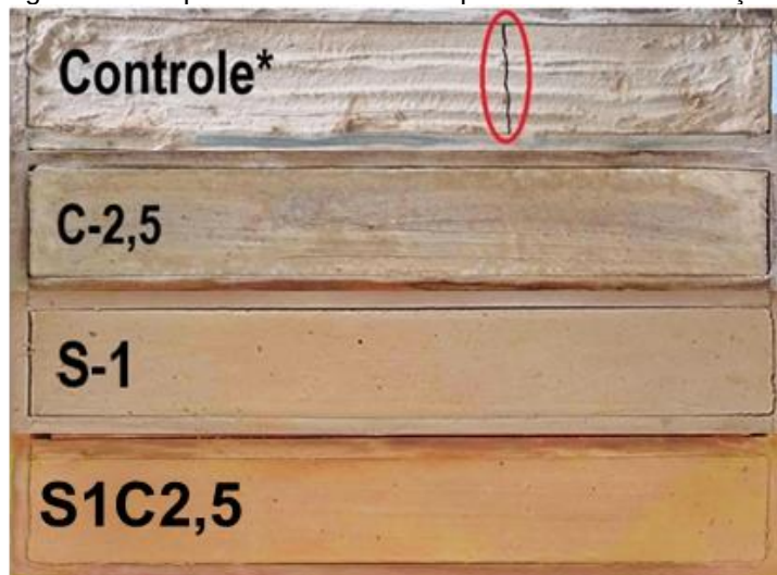
Figura 41 - Aspecto das amostras após o ensaio de retração.
