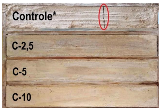
Figura 26 - Aspecto das amostras após o ensaio de retração
