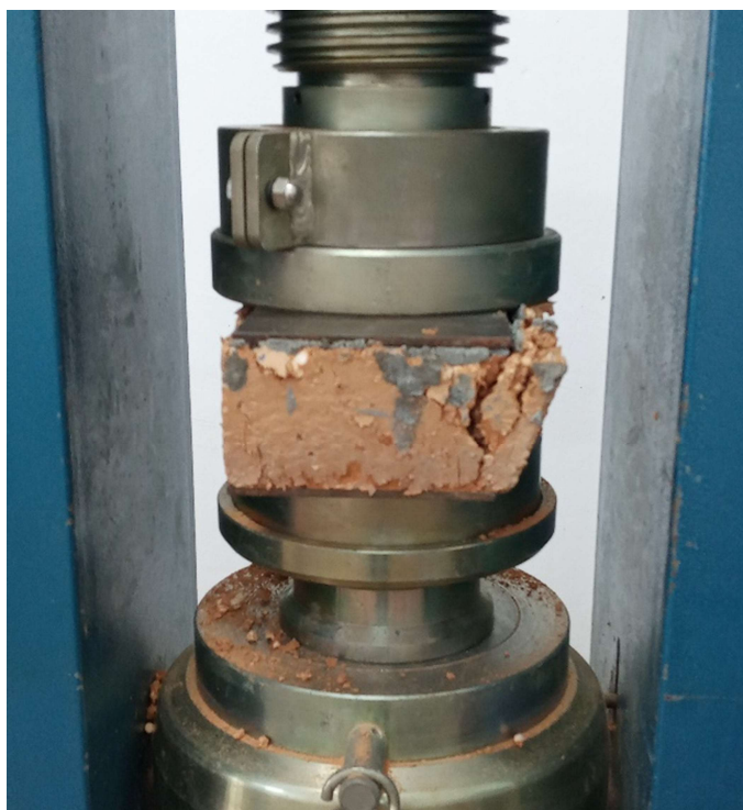
Figura 20 - Ensaio de Resistência à Compressão.
