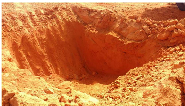
Figura 15 - Abertura realizada para extração da amostra.
