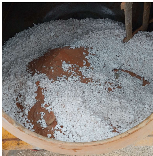
Figura 17 - Resíduo de poliestireno expandido processado.
