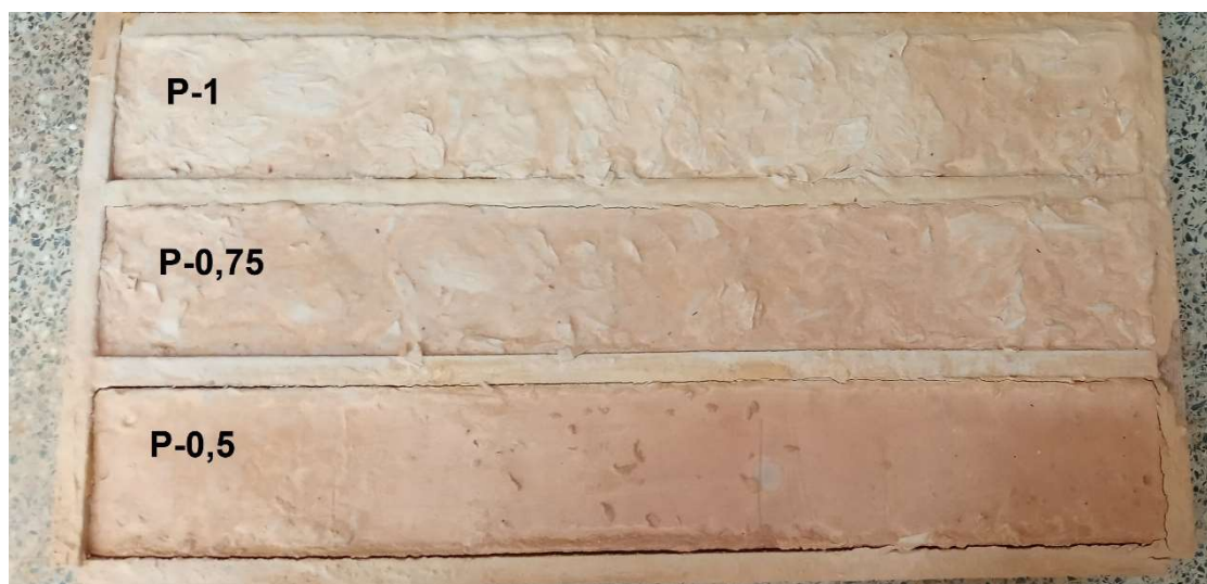
Figura 31 - Ensaio de retração: fibras de polietileno
