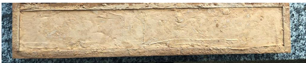
Figura 34 - Ensaio de retração: fibras de polietileno e adição de EPS
