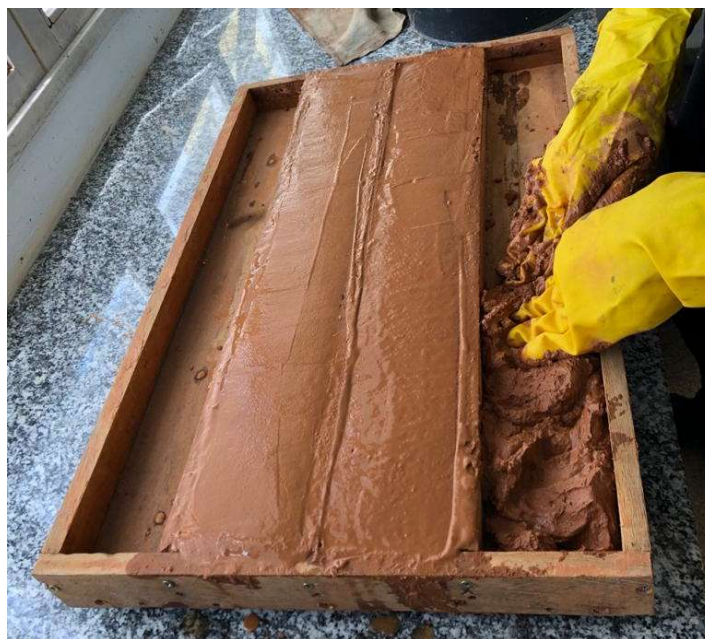
Figura 21 - Mistura disposta na caixa para análise de retração.
