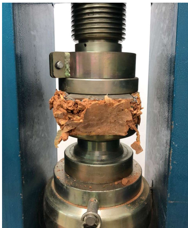
Figura 30 - Bloco no estado de deformação limite.
