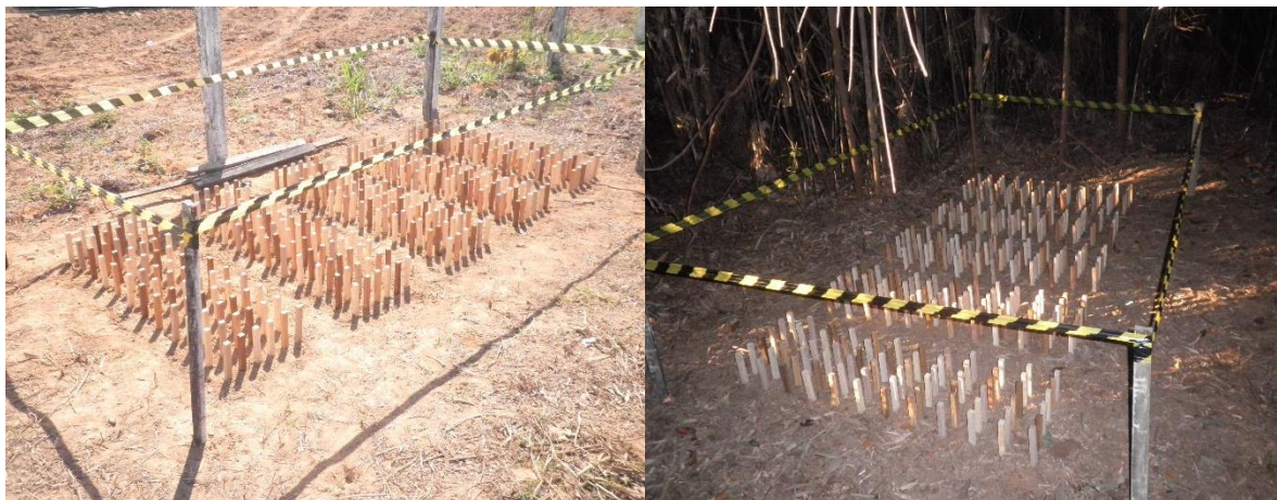
Figura 3. Distribuição dos corpos de prova em ambiente de campo aberto (esq.) e distribuição dos corpos de prova em ambiente de floresta (dir.)
