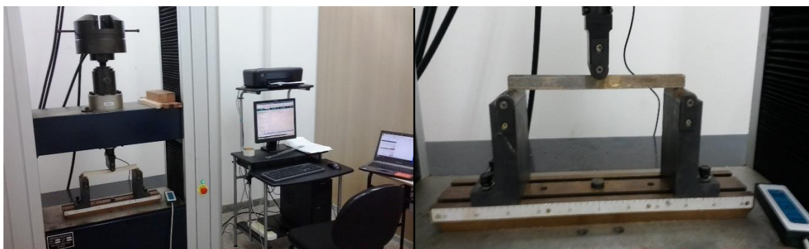
Figura 6. Máquina Universal de ensaios com capacidade de 300 kN (quilonewton)
