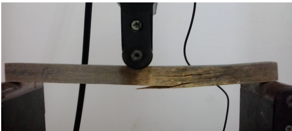
Figura 17. Peça sob teste de flexão estática sofrendo ruptura na região submetida ao solo
