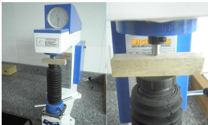
Figura 5. Durômetro de bancada dotado de penetrador esférico (1/4")
