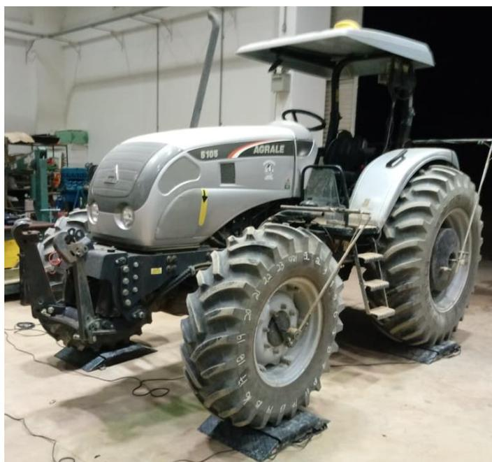
**Figura 2** - Trator utilizado no experimento, equilibrado sob balanças de pesagem para adequação de massa.
