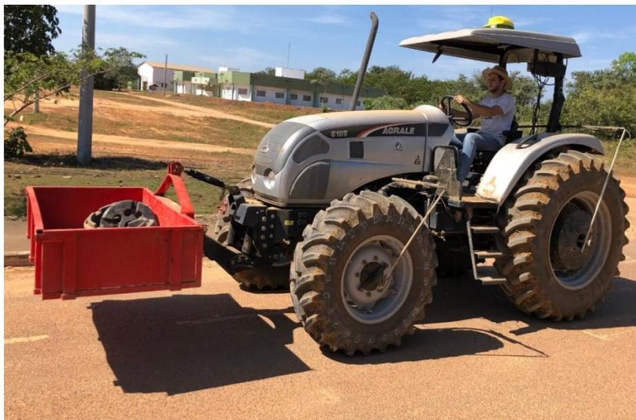
**Figura 3** - Plataforma carregada com lastros sólidos e devidamente nivelada.
