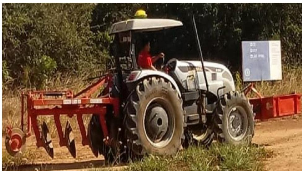
**Figura 4** - Arado de discos montado ao trator conjuntamente com a plataforma.
