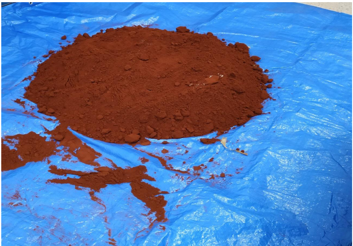
Figura 1. Homogeneização manual do substrato sobre lona plástica, com auxílio de uma enxada; feita no laboratório de fitopatologia da UFMT/CUA (FOTO: Daniel Junior Batista de Amorim 2019).
