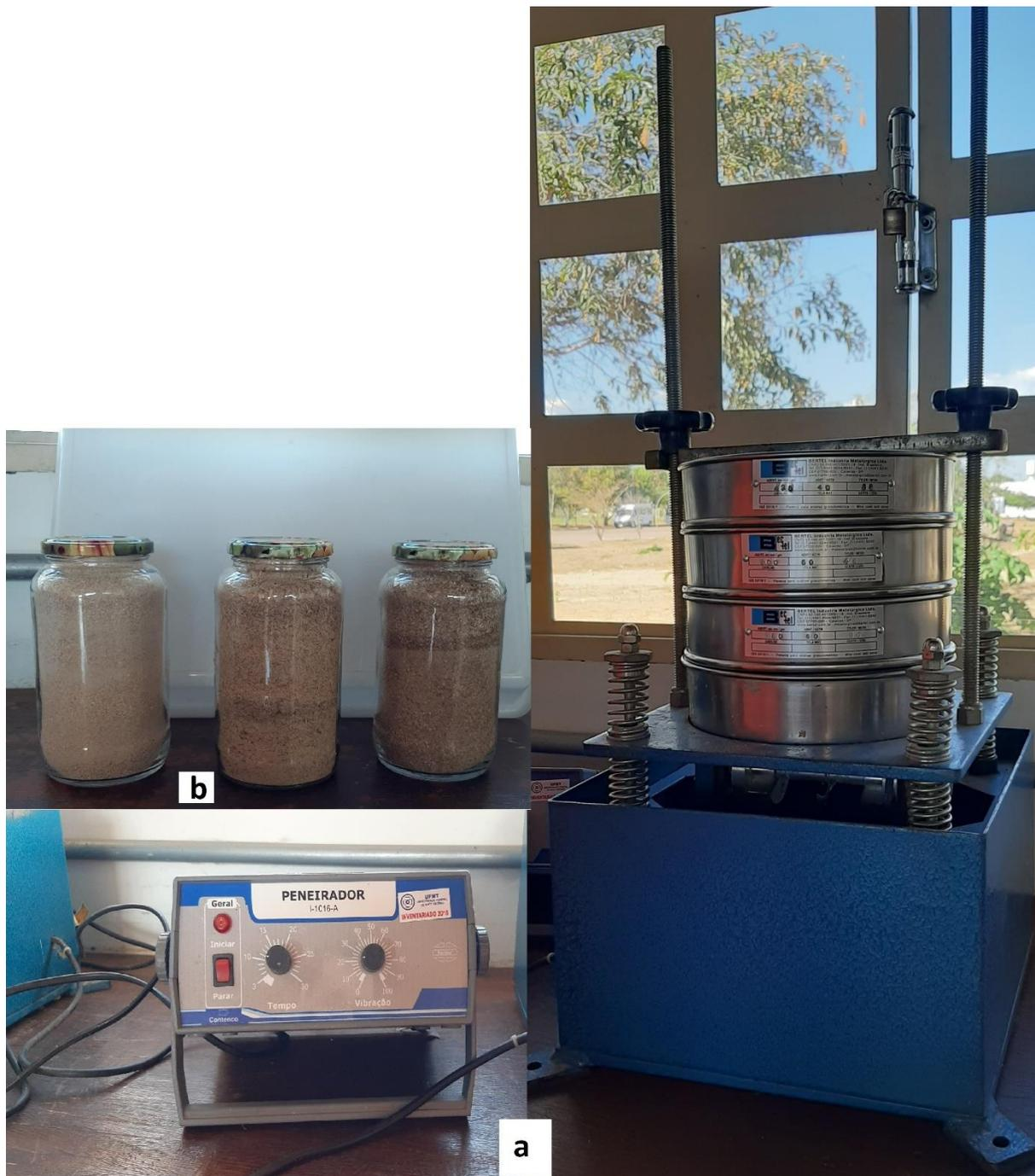
**Figura 5.** (a) Peneirador eletromecânico; (b) os potes com amostra após trituração no moinho.
