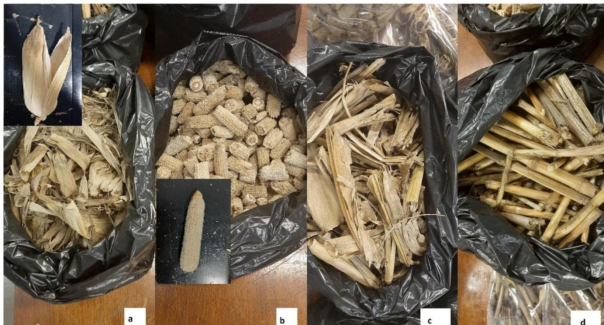
**Figura 2.** Amostras segregadas e selecionadas para boa representatividade. (a)Palha (parte que envolve os grãos na espiga), (b)Sabugo, (c)Folhas, (d) caule.
