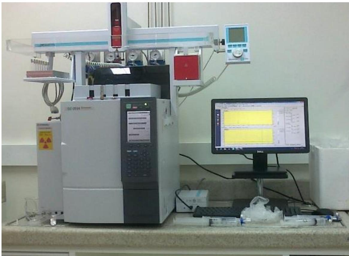
**Figura 7** - Cromatógrafo gasoso do laboratório da Embrapa Agrossilvipastoril equipado com detectores de captura de elétrons e ionização de chamas para quantificar os gases de efeito estufa ( $\text{N}_2\text{O}$ ,  $\text{CH}_4$  e  $\text{CO}_2$ ) e salvar os dados no computador conectado a ele.
