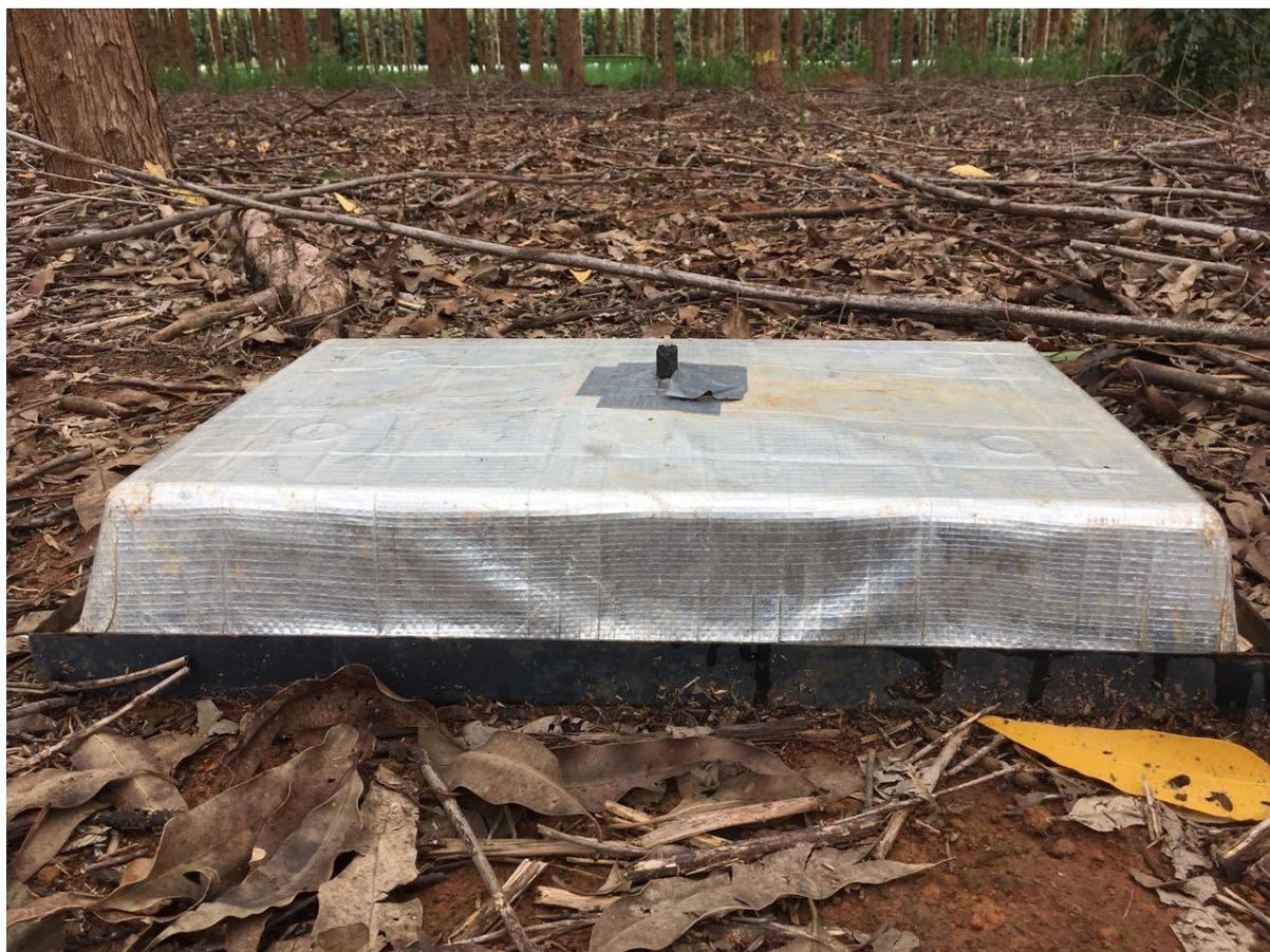
**Figura 5** - Topo instalado no campo, feito de bandeja de policloreto de vinil revestido com manta térmica. Foto: Alexandre Ferreira do Nascimento (EMBRAPA, 2019, p. 548).
