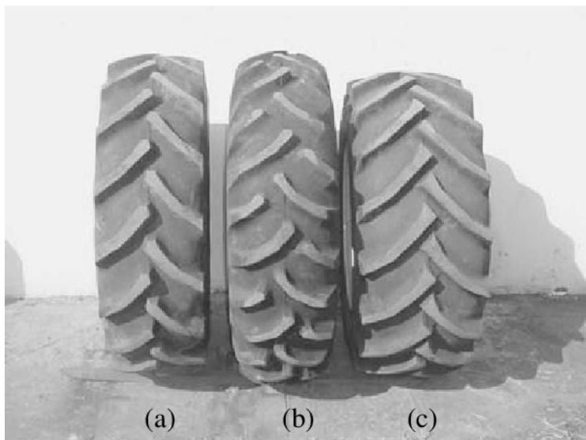
Figura 03: Tipos construtivos de pneus, radial (a), diagonal (b) e bpaaf (c). Fonte: (Mazetto *et al.* 2004).
