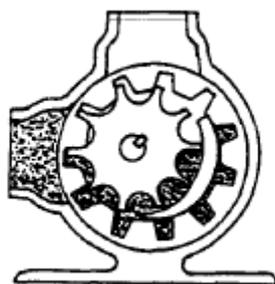
Figura 08: Bomba de engrenagem de dentes internos. Fonte: (Ferreira, 2013)
