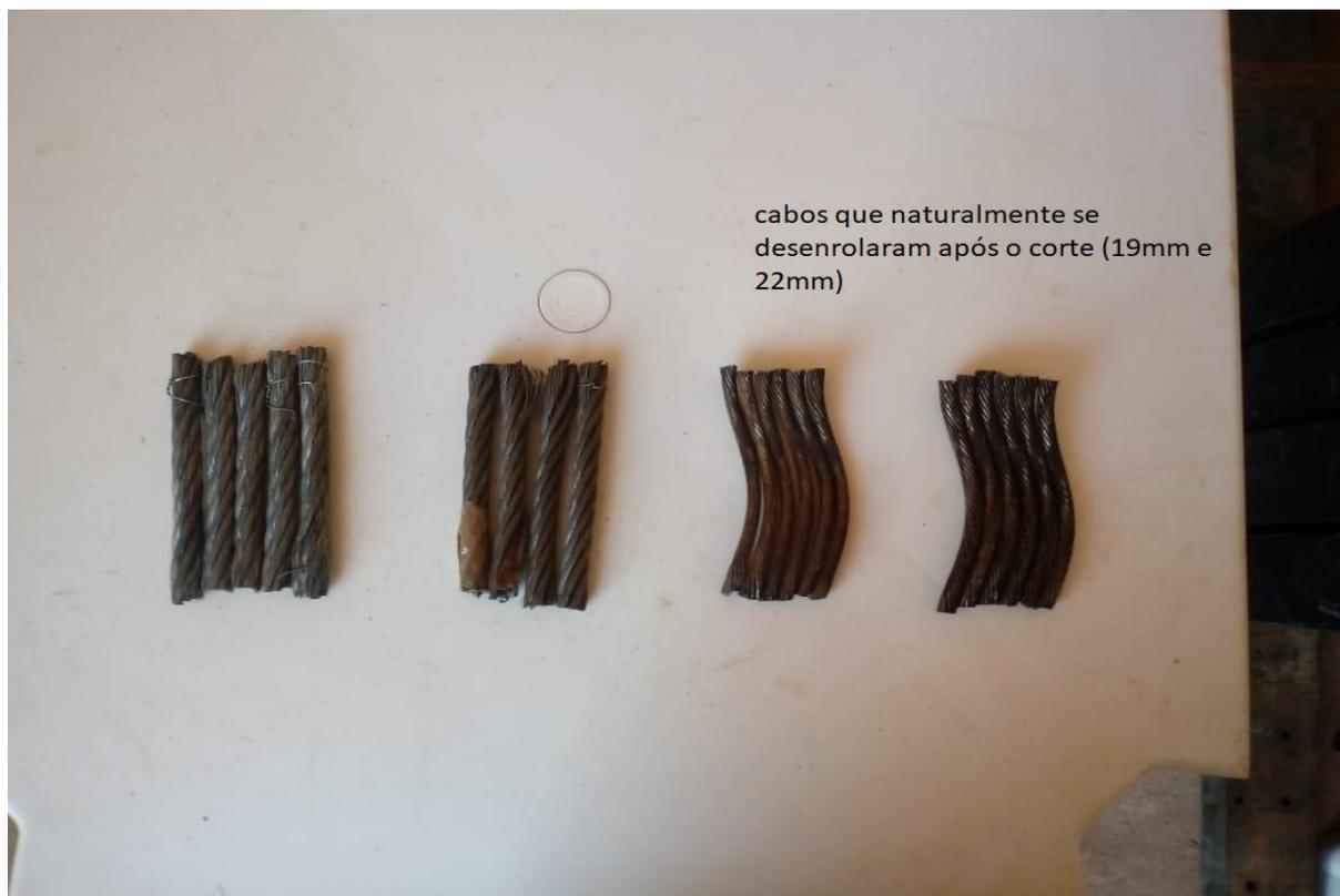
Figura 55: podemos observar que os cabos de diâmetro maior se desenrolaram e não puderam ser testados, já os de diâmetro de 13 mm e 16 mm foram testados normalmente.
