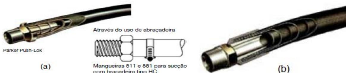
Figura 29: (a) Por interferência entre a conexão e mangueira e (b) por meio de uma capa rosqueável, sem descascar a extremidade da mangueira. Fonte: Apostila M2001 – 2 BR, Tecnologia hidráulica industrial – Parker.
