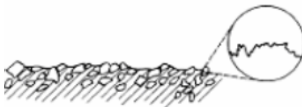
Figura 19 – Superfície com microtextura rugosa e macrotextura fechada
