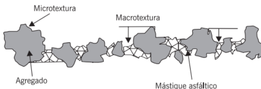
Figura 16 – Micro e macrotextura na superfície de um revestimento asfáltico
