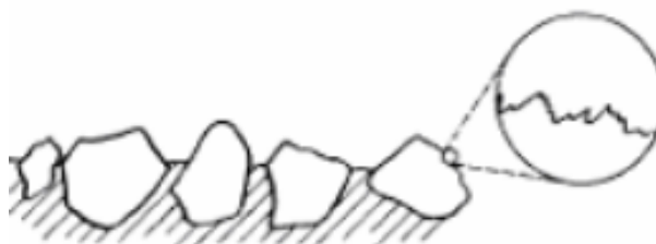
Figura 18 – Superfície com microtextura rugosa e macrotextura aberta
