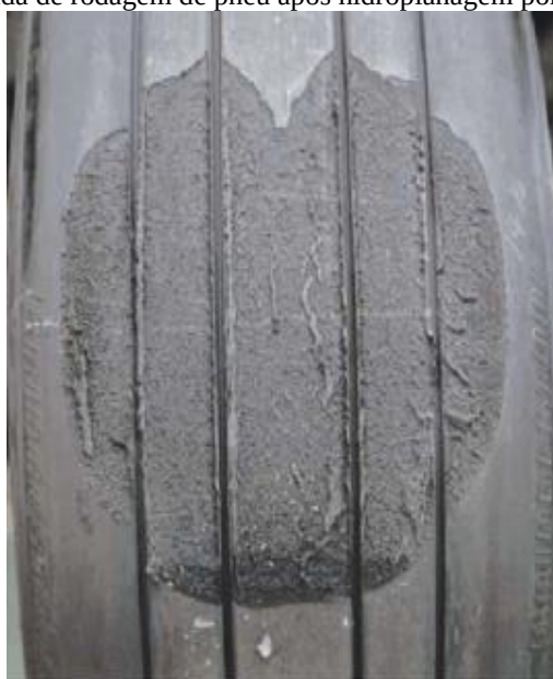
Figura 25 – Banda de rodagem de pneu após hidroplanagem por desvulcanização
