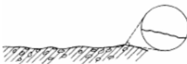
Figura 21 – Superfície com microtextura polida e macrotextura fechada
