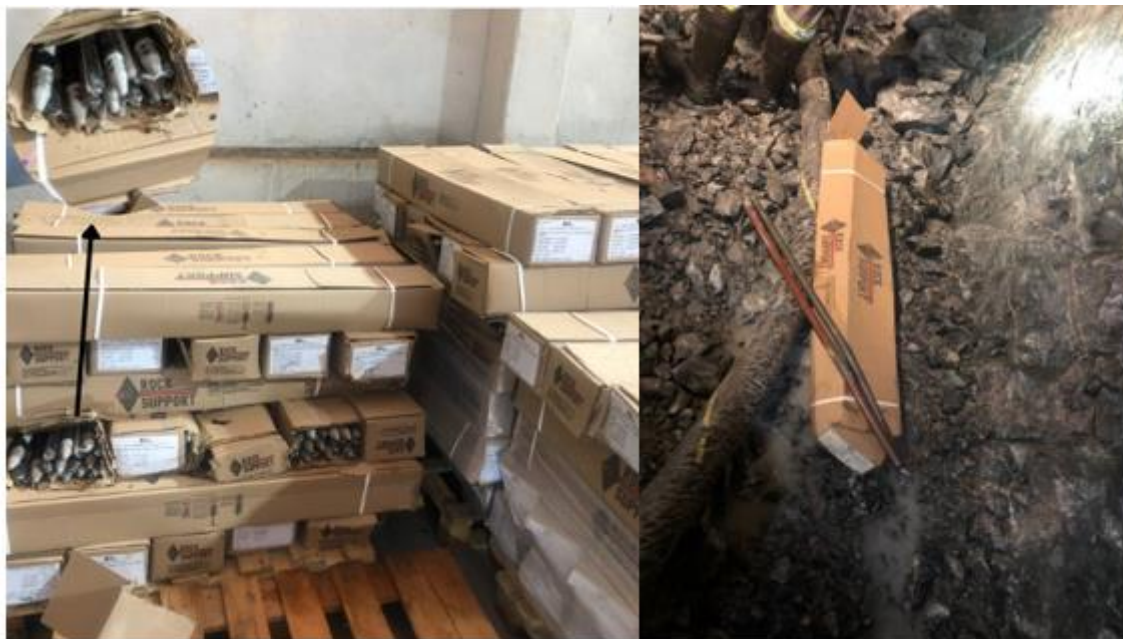
Figura 30 - Falhas de armazenamento da resina.
