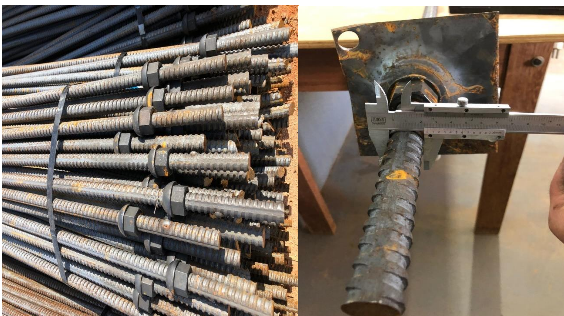
Figura 17 - Tirante helicoidal e diâmetro nominal
