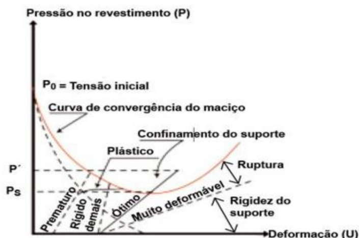
Figura 4 - Interação entre o maciço/suporte.
