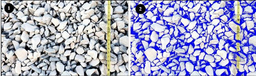
Figura 12: Exemplo de fotografia ampliada para a análise de distribuição de tamanhos no software Split Desktop.
