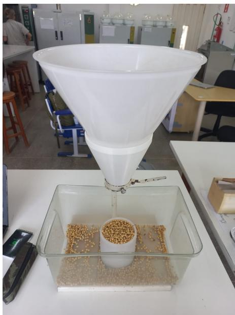
**Figura 7** - Aparato para determinar massa específica aparente de grãos.
