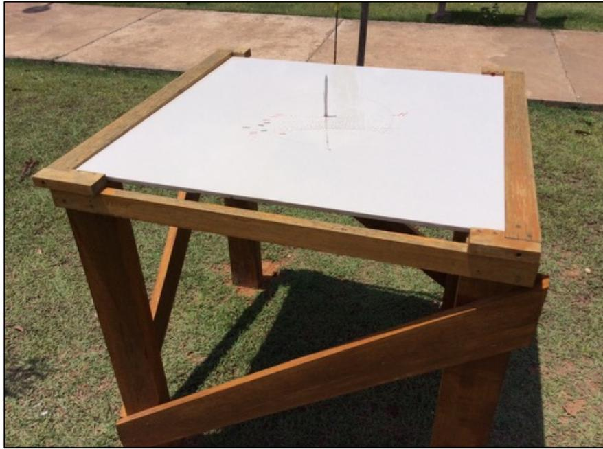
Figura 1: Estrutura e Gnômon instalados para marcações do comprimento das sombras.
