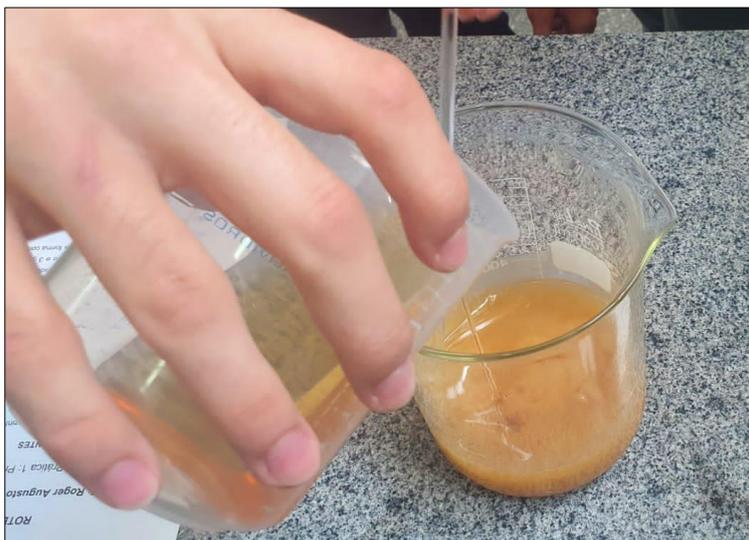
**Figura 14: Mistura do óleo com a solução de soda caustica**
