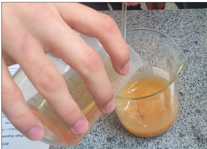
**Figura 7: Mistura do óleo com a solução de soda caustica**
