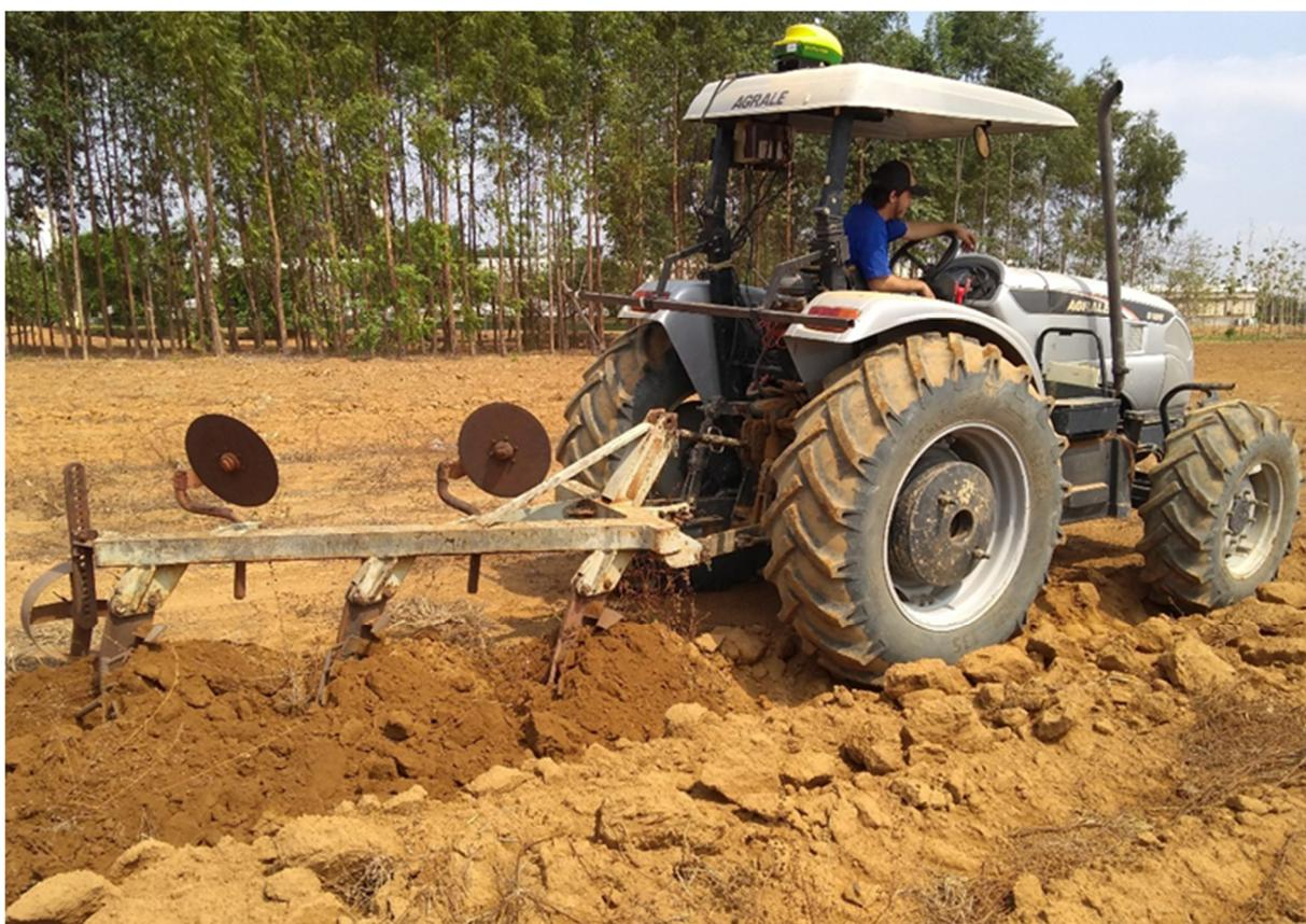
Figura 15: Trator agrícola de 105 cv lastrado e com instrumentação instalada, acoplado a um arado com 3 aivecas durante as coletas de dados de campo.
