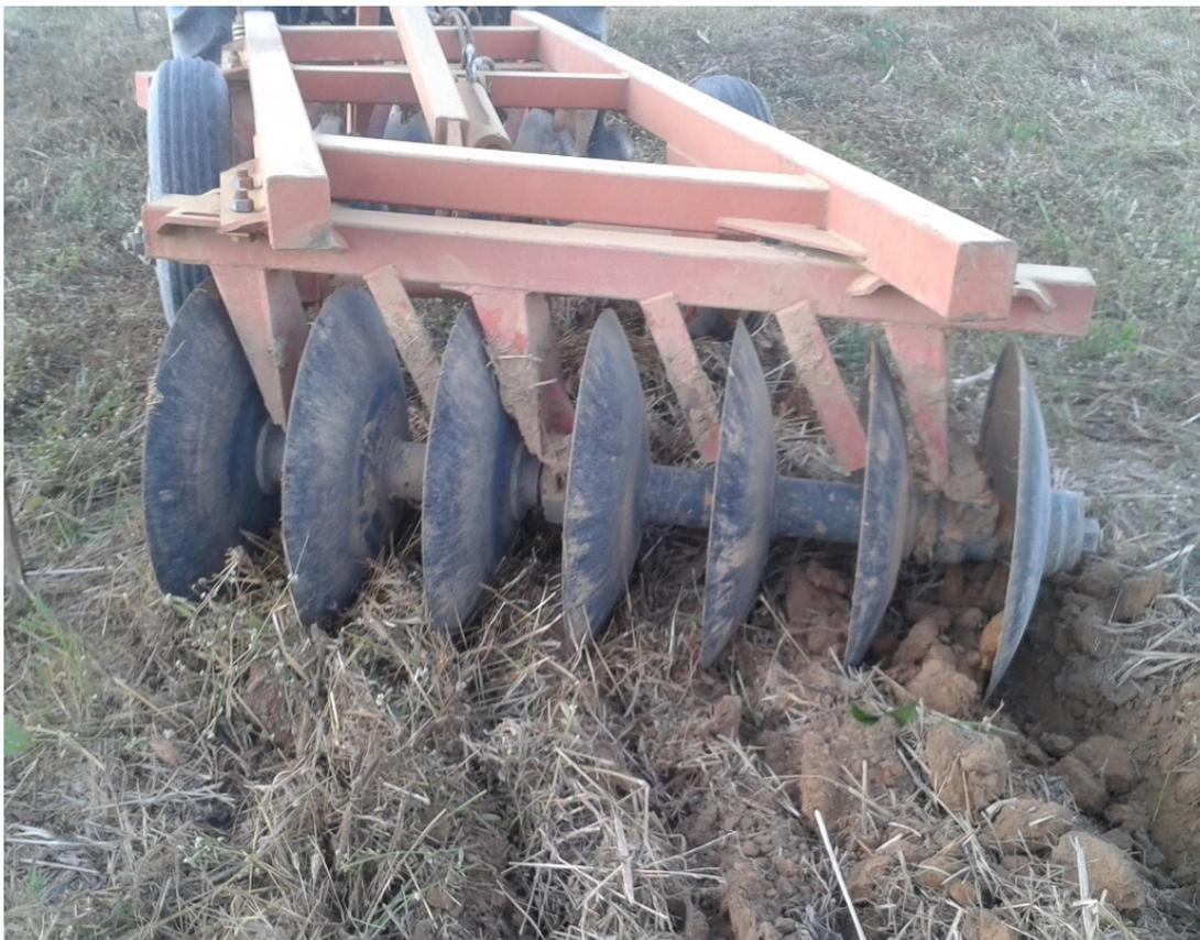
Figura 11: Grade com 14 discos de 28 polegadas de diâmetro (711,2 mm) durante as coletas de dados de campo. Solo com baixa umidade.
