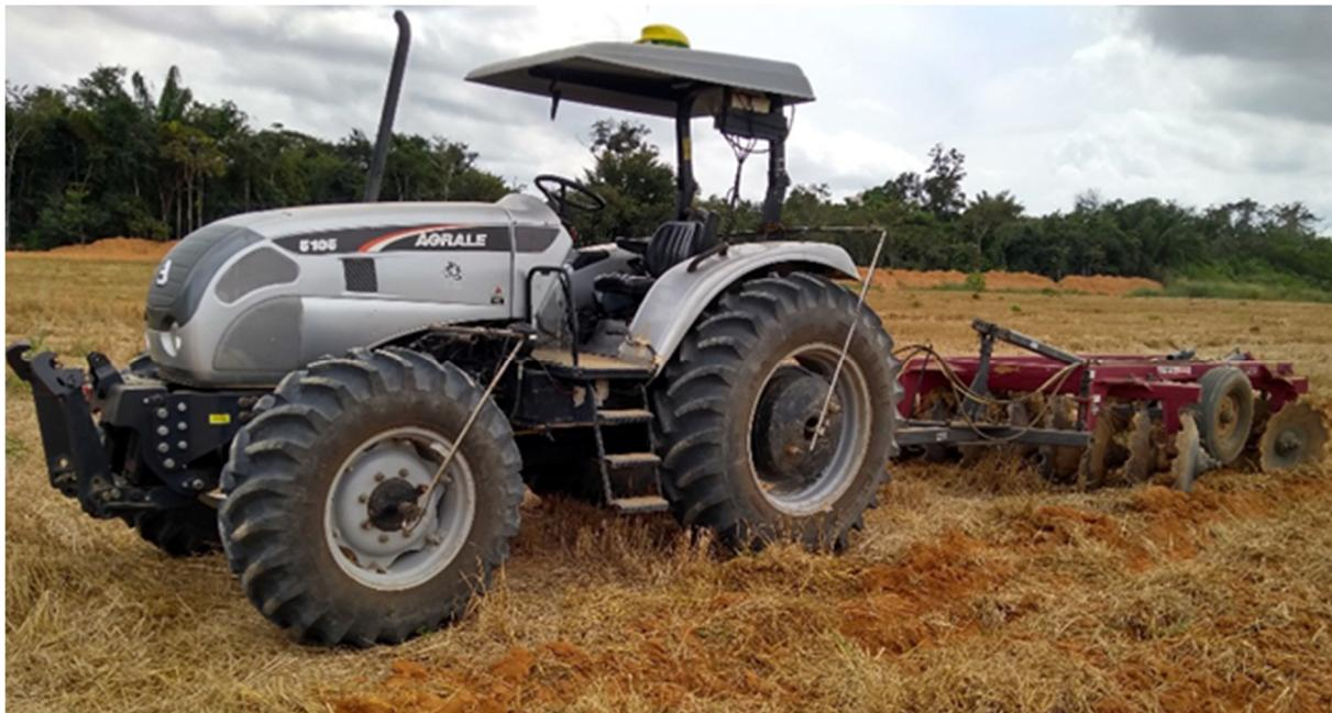
Figura 10: Trator agrícola de 105 cv lastrado e com instrumentação instalada, acoplado a grade de 16 discos de 30 polegadas de diâmetro (762 mm) durante as coletas de dados de campo. Solo com baixa umidade.
