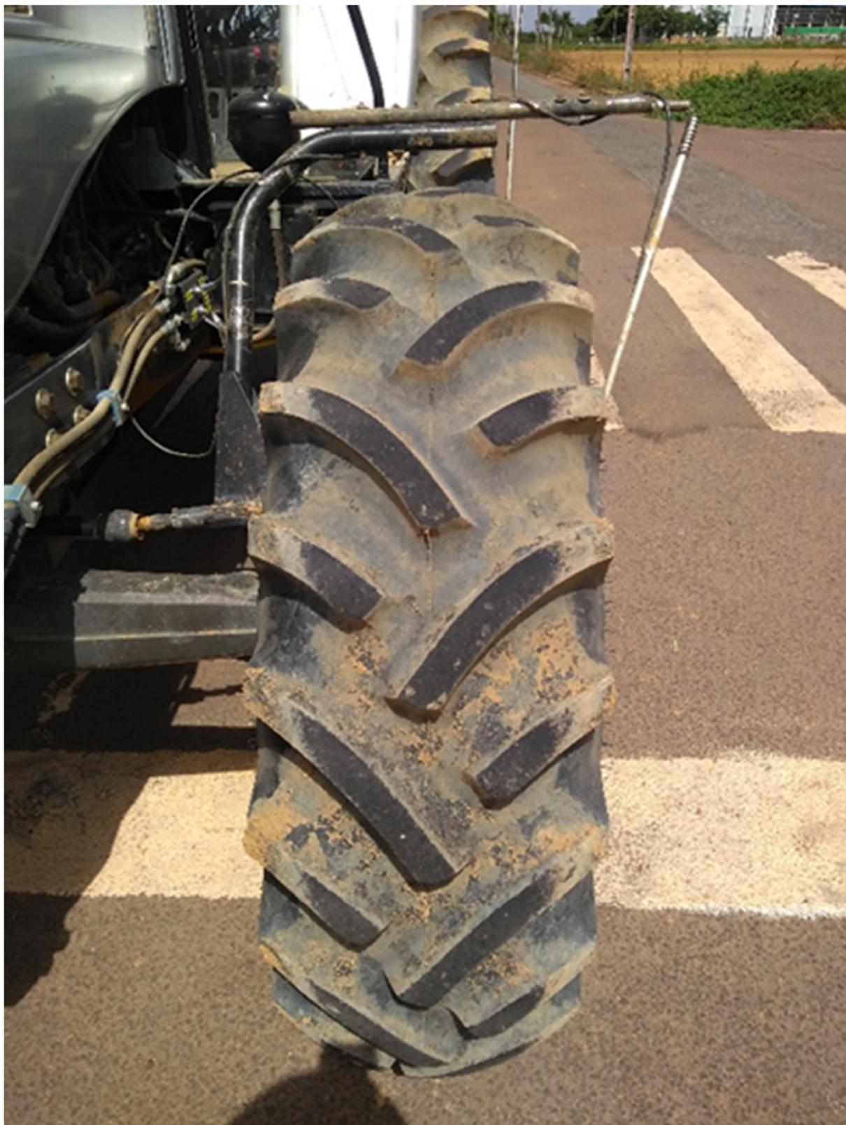
Figura 9: Detalhe de um encoder instalado no centro da roda motriz dianteira.
