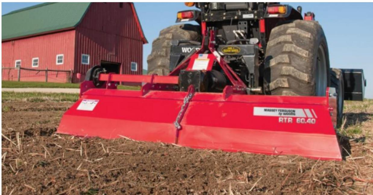
Figura 1. Enxada rotativa equipada com encanteirador executando trabalho de campo. Fonte: Volmaq.
