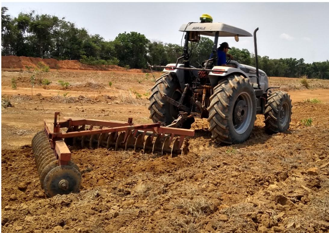
Figura 12: Trator agrícola de 105 cv lastrado e com instrumentação instalada, acoplado a grade niveladora de 28 discos de 20 polegadas de diâmetro (508 mm) durante as coletas de dados de campo.
