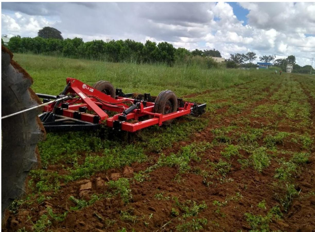
Figura 13: Subsolador de 5 hastes espaçadas em 450 mm e com profundidade de trabalho de 28 cm durante as coletas de dados de campo.
