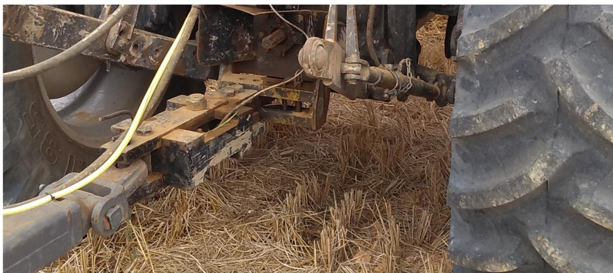
Figura 8. Suporte tipo berço com célula de carga, instalado no trator em substituição a barra de tração original e acoplado ao cabeçalho de uma das grades.
