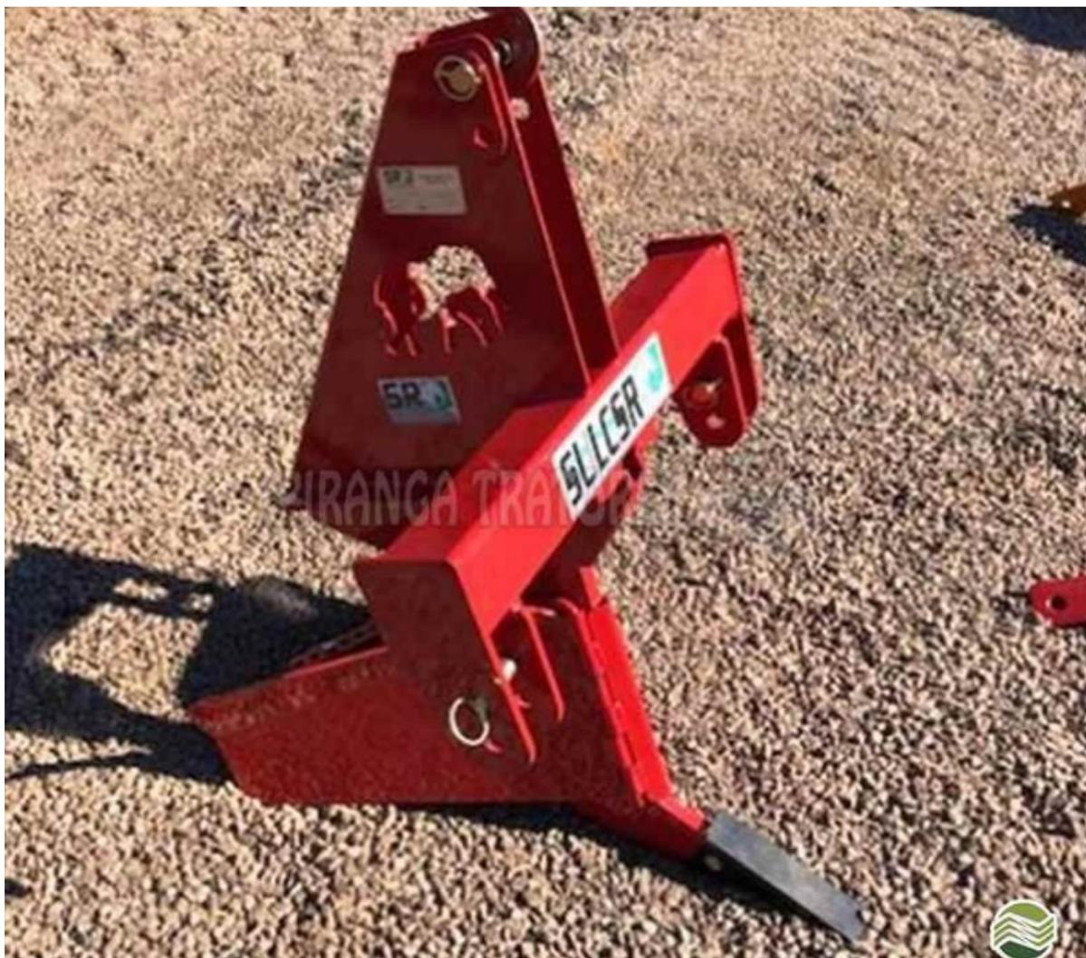
Figura 2. Sulcador utilizado para implantação de culturas via sulco. Fonte: Ipirangatratores.
