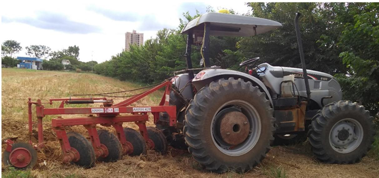
Figura 14: Trator agrícola de 105 cv lastrado e com instrumentação instalada, acoplado ao arado com 4 discos de 28 polegadas (711,2 mm) durante as coletas de dados de campo. Solo com baixa umidade.
