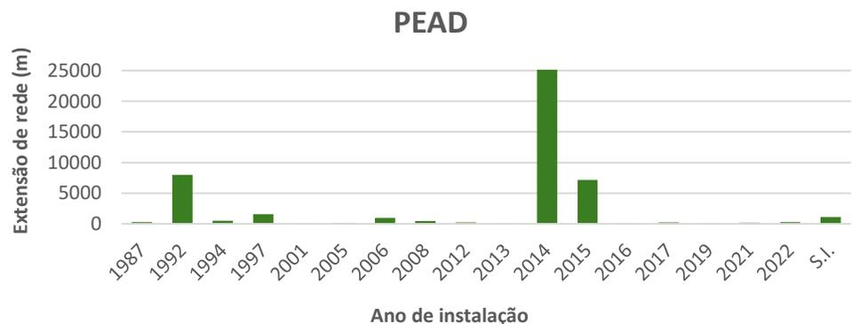
Gráfico 8 - Relação do ano de instalação com a extensão de rede para as tubulações de PEAD.
