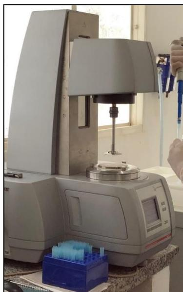
**Figura 4:** Reômetro rotacional, tipo cone placa, modelo MCR 102 da Anton Paar®
