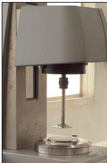
**Figura 5:** Representação esquemática da geometria cone placa utilizado no estudo
