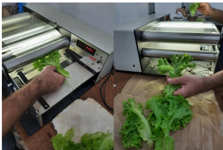
Figura 13 - Medição da área foliar. Equipamento LI-3100C Area Meter da Biosciences.
