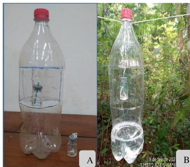
**Figura 6.** (A) Armadilha etanólica adaptada do Modelo ESAL-84, confeccionada com garrafa pet transparentes de 2 litros. (B) Armadilha instalada no campo.
