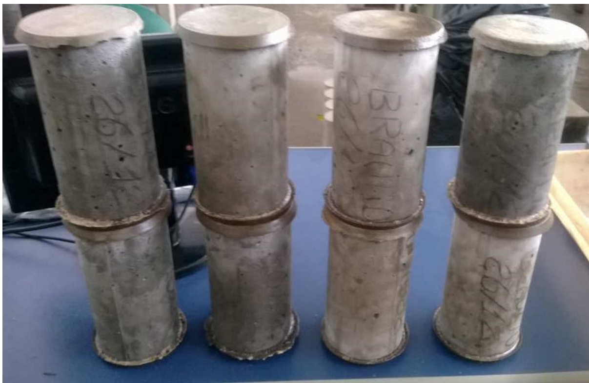
Figura 4- Corpos de prova antes de serem rompidos
