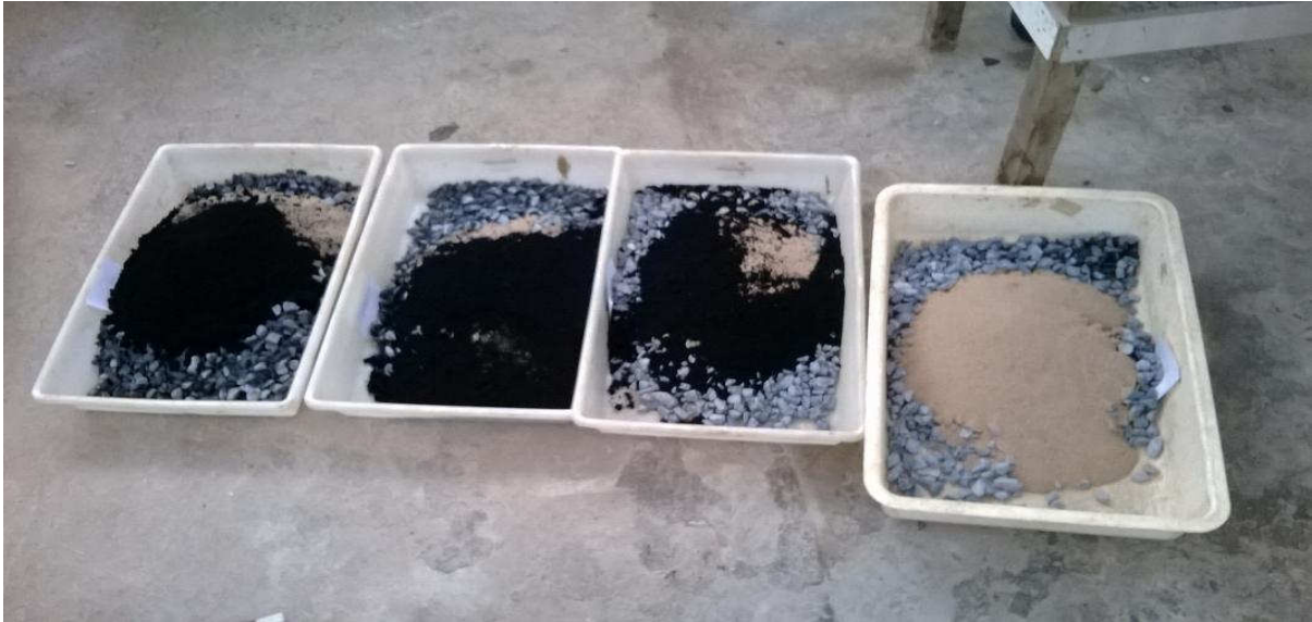
Figura 3- Dosagem dos materiais
