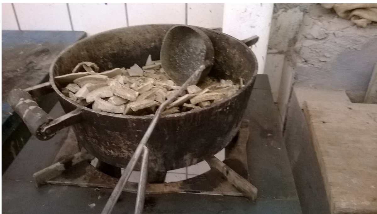
Figura 5- Aquecimento do enxofre
