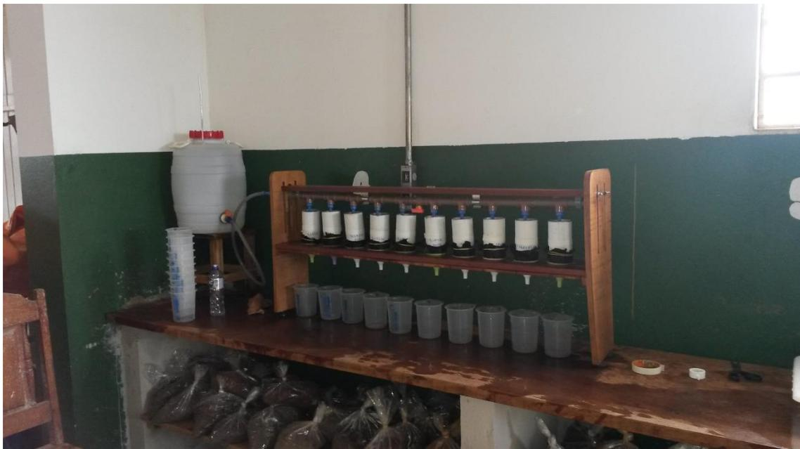
**Figura 4:** permeametro de carga constante usado para determinação da condutividade hidráulica em solo saturado.
